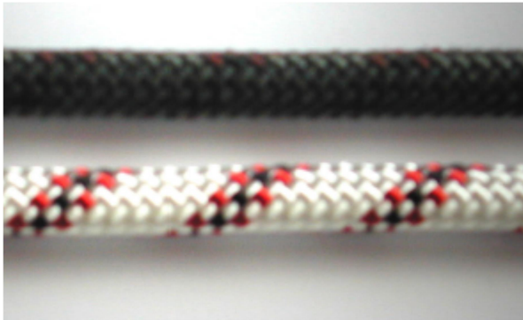
Rys. 3: Czernienie liny spowodowane pyłem od hamowania
