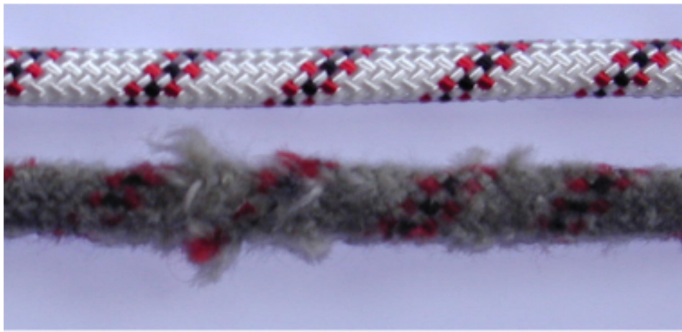
Rys. 2: Poważne zużycie liny, wytarcie ze zgrubieniem liny
