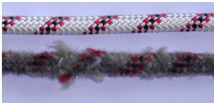
Rys. 2: Poważne zużycie liny, wytarcie ze zgrubieniem liny
